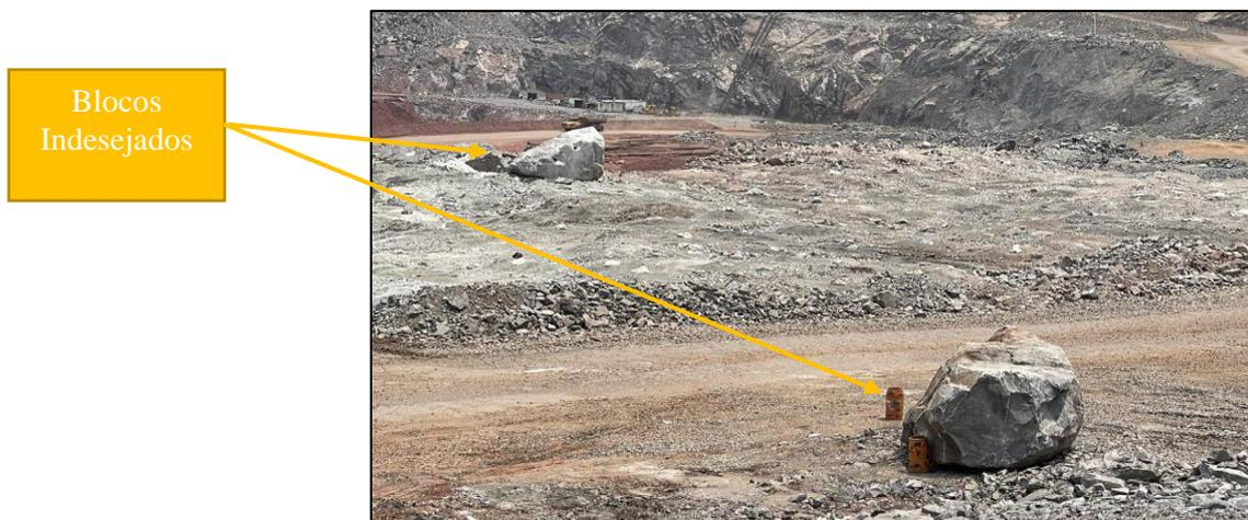
Figura 18 - Blocos indesejados produzidos pelo desmonte de rocha na SMC
