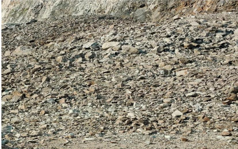
Figura 24 - Resultado da fragmentação do Bloco 33-21
