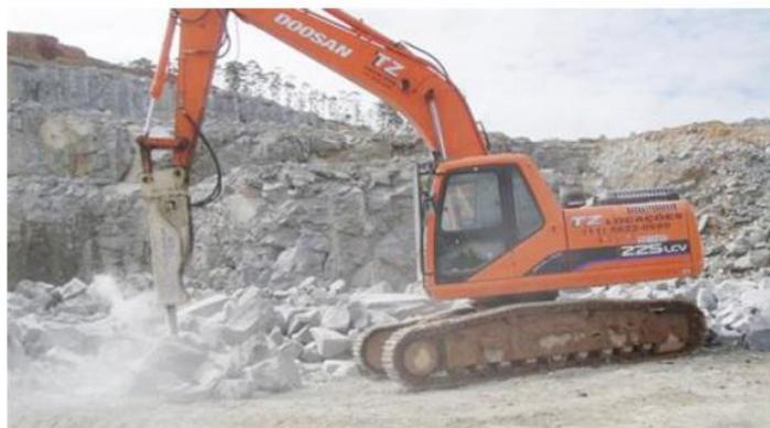
Figura 7 - Escavadeira equipada com um rompedor hidráulico (Site TZ Rental, 2014)
